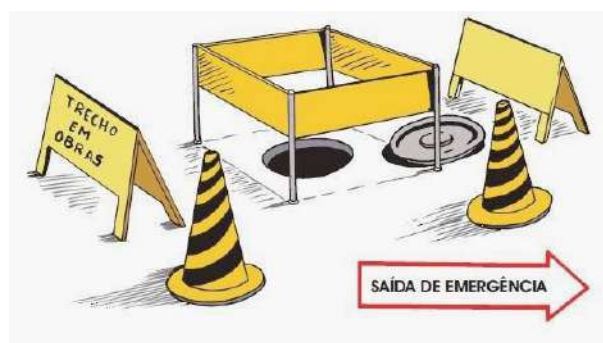
Figura 08: Equipamentos de Proteção Coletiva. Fonte: Instituto SC (2018)
